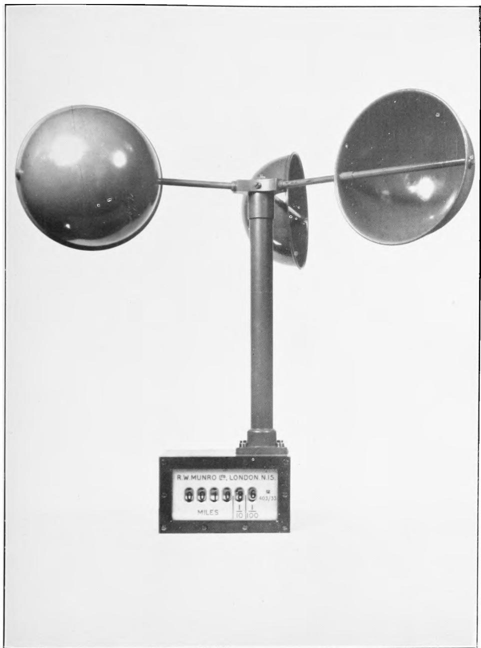
FIG. 1.--3-CUP ANEMOMETER
